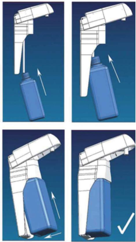
**3. Dosierpumpe einsetzen**
