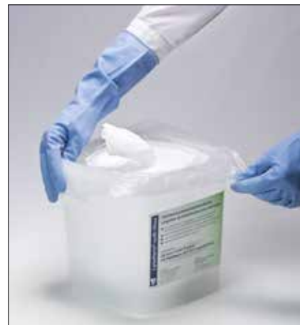
3. Folienbeutel öffnen und über den Eimer rand ziehen. Dann die Desinfektionslösung gem. Herstelleranweisung zugeben. Durchtränkung abwarten (mind. 30 Minuten).
